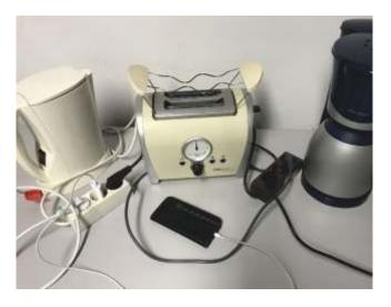
Leistungsaufnahme von 1.200 bis zu 2.000 Watt. Hier käme es also unweigerlich beim gleichzeitigen Benutzen der Geräte zu einer elektrischen Überlastung (Überhitzung!!!).
